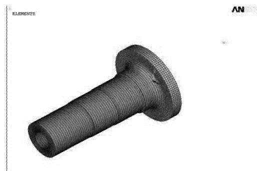
图 10 2MW 级转子轴的有限元模型
