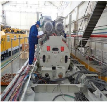
按照4400马力机车工艺分工要求,公司新产品4400马力内燃机车的柴油机与主发电机的整备连接及同轴度调整工作,由机车事业部调整到柴油机车间。
