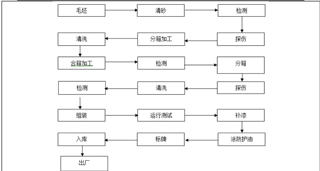
图 2-12 轨道交通齿轮箱加工工艺流程图
