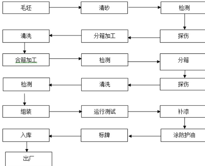
图 2-2 兆瓦级风电齿轮箱加工工艺流程图
